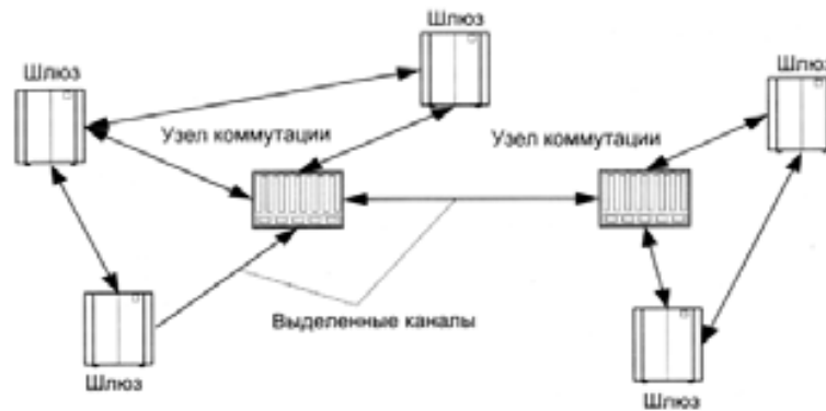
Рисунок 1.2. Приклад побудови виділеної мережі IP-телефонії
