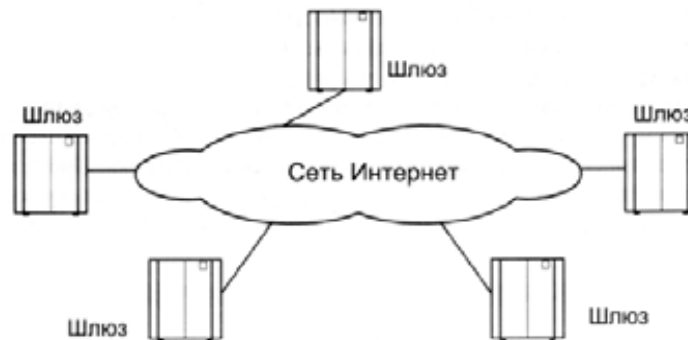
Рисунок 1.3. Приклад побудови інтегрованої мережі IP-телефонії
